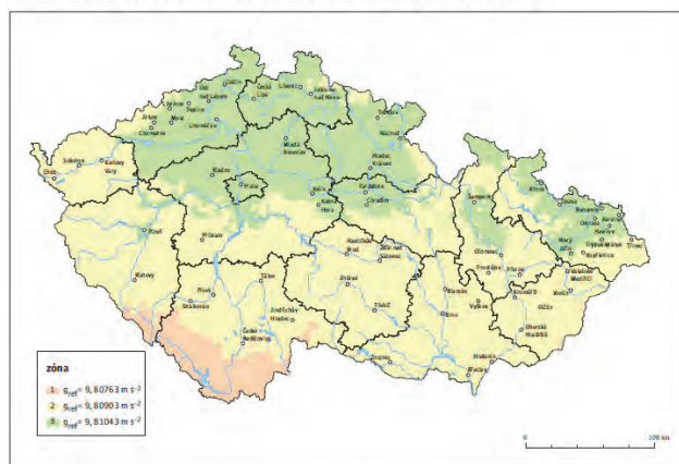
Obr. 2: Grafické zobrazení zón tíhového zrychlení pro skupinu vah třídy přesnosti II
