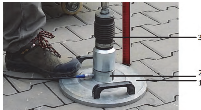
Obř. 1: Detail lehké dynamické desky, význam odkazů, viz popis níže; kabel jdoucí od pouzdra (2) s absolutním snímačem vede k elektronické vyhodnocovací jednotce
