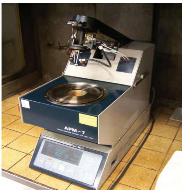
Obr. 4: Přístroj na stanovení bodu vzplanutí v uzavřeném kelímku podle Penskyho-Martense
