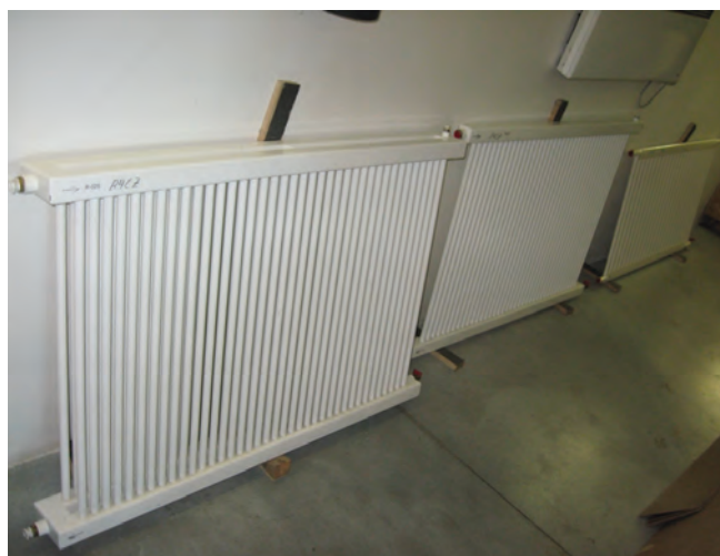
Obr. 4: Referenční (sekundární) sada vzorků otopných těles podle normy ČSN EN 442-2: 2015.
