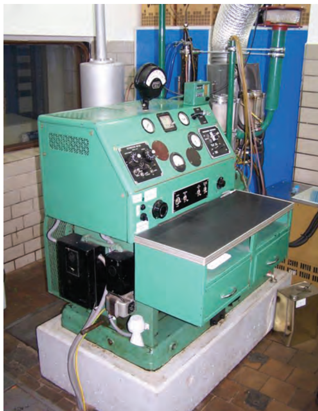
Obr. 1: Motor pro stanovení oktanových čísel WAUKESHA
