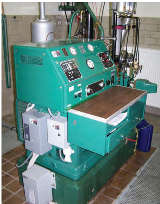
Obr. 3: Motor pro stanovení cetanového čísla WAUKESHA
